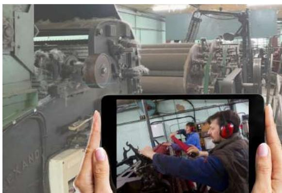
Suite de la découverte des machines. Ci-contre, la **fileuse** avec ses trois phases successives : l'étirement, la torsion et l'embobinage.
